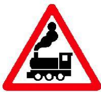
1.2 «Железнодорожный переезд без шлагбаума»
